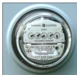
Ancienne version d'un compteur d'électricité
