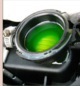
L'antigel est une solution avec un liquide dissout dans un autre liquide
