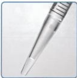
Figure F Il reste toujours un peu de solution dans la pointe de la pipette. Ne l'enlève pas.
