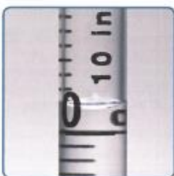
Figure C Commence par pomper plus de solution inconnue qu'il n'en faut. L'excédent s'écoulera au cours des deux prochaines étapes.
