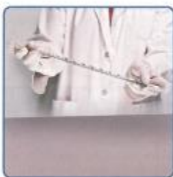
Figure B Recouvre les bouts de la pipette pour empêcher la solution de s'échapper. Remue la pipette dans un mouvement de va-et-vient pour recouvrir sa paroi intérieure de solution.
