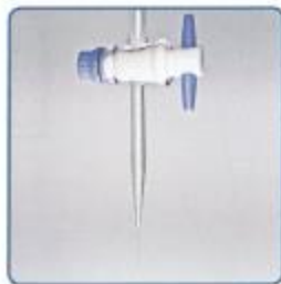
Figure G Le robinet est grand ouvert quand la manette est parallèle à la burette. La solution s'écoule alors rapidement.
