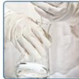
Figure J Agite l'erenmeyer lorsque tu ajoutes du titrant. Si tu as du mal à remuer l'erenmeyer tout en ajoutant du titrant, utilise un agitateur magnétique ou demande à une autre personne de remuer pendant que tu ajoutes le titrant.
