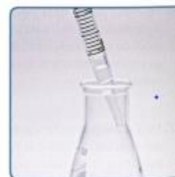
Figure E Vide la pipette en appuyant la pointe sur la paroi de l'erenmeyer pour éviter les éclaboussures.
