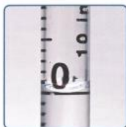
Figure D Lis toujours le volume de la solution au bas du ménisque.
